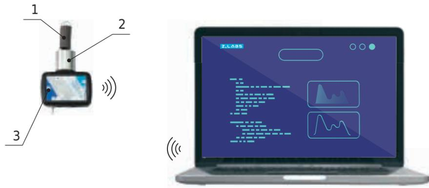
Схема установки: 1 – пружина, 2 – груз, 3 – датчик ускорения
