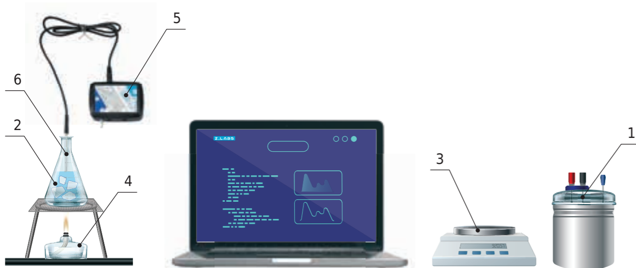
Схема эксперимента: 1 – калориметр, 2 – колба со смесью льда и воды, 3 – весы, 4 – спиртовка, 5 – мультидатчик, 6 – температурный зонд
