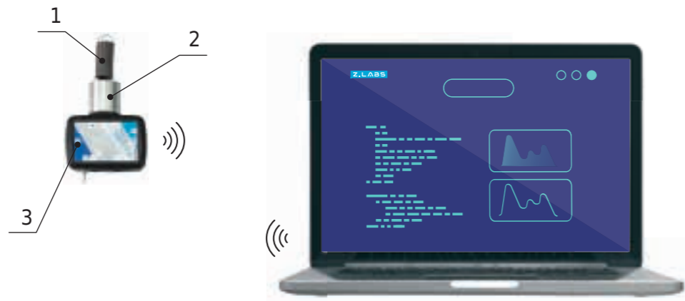
Схема установки: 1 – пружина, 2 – груз, 3 – датчик ускорения
