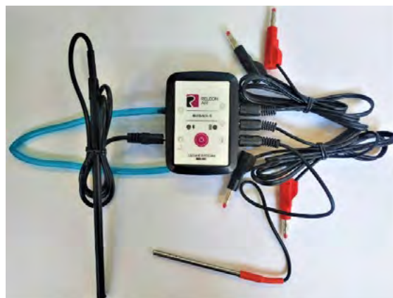
Рис. 9. Беспроводной мультидатчик Releon Air «Физика-5»
