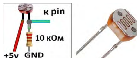
Рис. 4. Схема подключения фоторезистора к Ардуино
